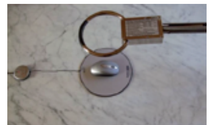
Abb. 7: Mauspad – Messung des Magnetfeldes mittels Hochfrequenz-Spektralanalyse
