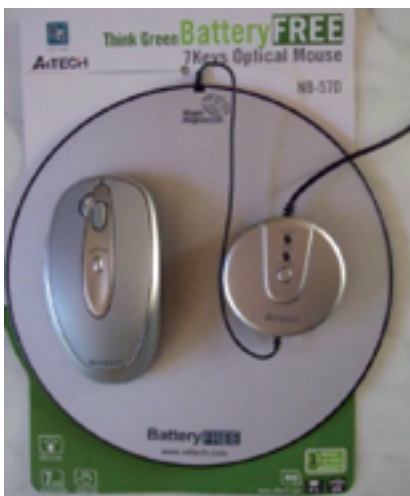
Abb. 3: Batteriefreie, drahtlose Maus mit Powerpad, Typ A4Tech NB-57D
