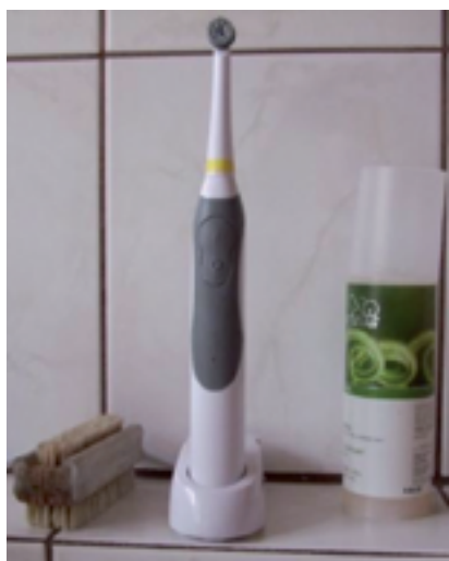
Abb. 1: Ein alltägliches Bild – Beispiel einer elektrischen Zahnbürste mit drahtloser Aufladung des internen Akkus (Typ Aldi DMV 2009)
